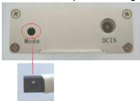
Récepteur infrarouge intégré.
