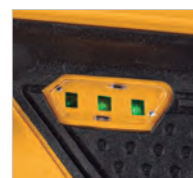
LEDs de estado de carga de la batería
