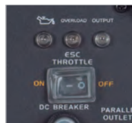
Interruptor ESC (control inteligente del motor)
