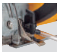
Refrigeración del disco por agua
