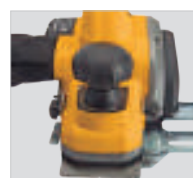
Ajuste de la profundidad de desbaste
