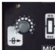
Régulateur du dévidage du fil
