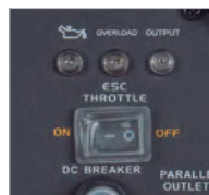
Interrupteur ESC (contrôle intelligent du moteur)
