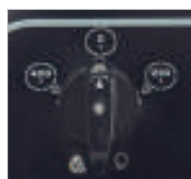
Sélection de la tension d'alimentation
