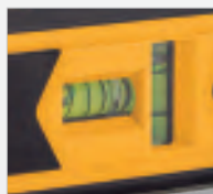
Nível de bolha de ar horizontal e vertical
