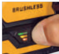
LEDs de estado da carga da bateria
