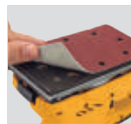
Fixação das lixas com velcro
