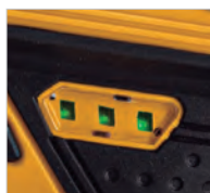
LEDs de estado da carga da bateria
