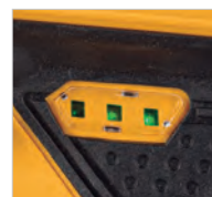
LEDs de estado da carga da bateria
