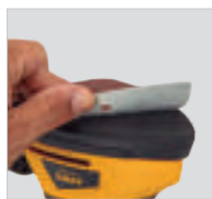
Fixação das lixas com velcro
