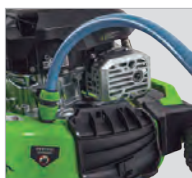
Permite ligação de mangueira para lavagem
